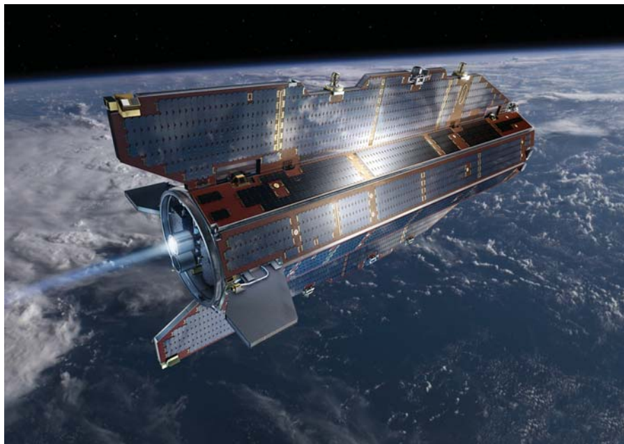
Figur 2. GOCE-satellitten. Gravity Field and Steady-State Ocean Circulation Explorer (GOCE) er en satellit til måling af jordens tyngdefelt opsendt i 2009 af ESA med danske videnskabsfolks deltagelse.
